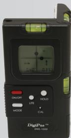
DWL 1000XY ist eine digitale 2-Achsen Pfosten-Wasserwaage mit einer Auflösung von 0,05°. Sie wurde für Handwerker und Spezialisten zum schnellen und exakten Aufstellen von Pfosten, Pfählen, Masten, Zäunen, Dachrinnen, Fenster- und Türrahmen entworfen.
